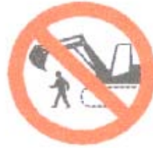
PROHIBIDO PERMANECER EN EL RADIO DE ACCIÓN DE LA MAQUINARIA
